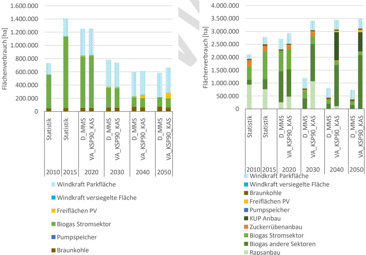
Abbildung 35: Flächenverbrauch des Stromsektors (links) und des gesamten Energiesystems (rechts)
