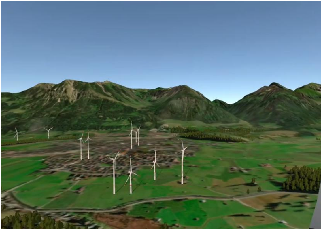
ABBILDUNG 21: VR-UMGEBUNG MIT IMMERSIVER DARSTELLUNG EINES GEPLANTEN WINDPARKS. DIE VOGELPERSPEKTIVE ERMÖGLICHT EINE REALITÄTSNAHE EINSCHÄTZUNG DER LANDSCHAFTLICHEN AUSWIRKUNGEN.
