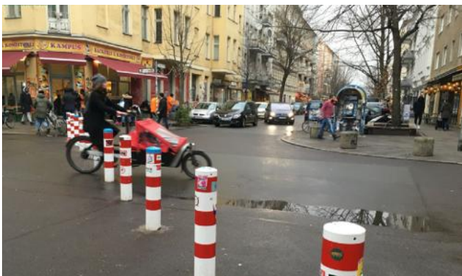
A.5 Linearer Modalfilter (temporär): Bereits ein einzelner Diagonalfilter kann als kostengünstige Sofortmaßnahme die Verkehrsströme im gesamten Superblock zugunsten des Umweltverbunds verändern. Sobald sich die Verkehrsführung bewährt hat, sollte die Kreuzung baulich mit blau-grüner Infrastruktur und barrierefrei gestaltet werden.
